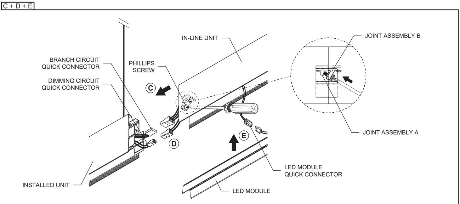
PENDANT IN-LINE SYSTEM - HIGH PROFILE DIRECT/INDIRECT MODEL: 3700
