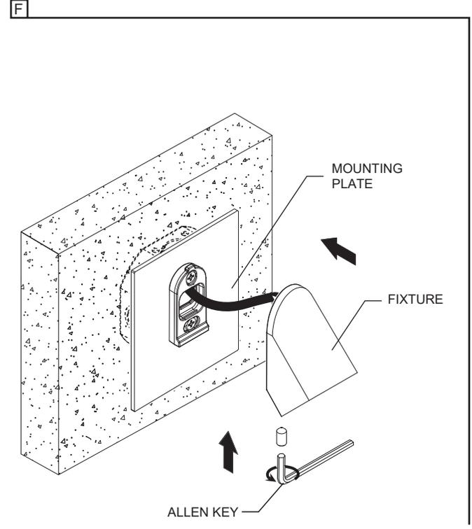
**2" SINGLE GANG BOX INSTALLATION WITH REMOTE DRIVER (J2-REM)**
